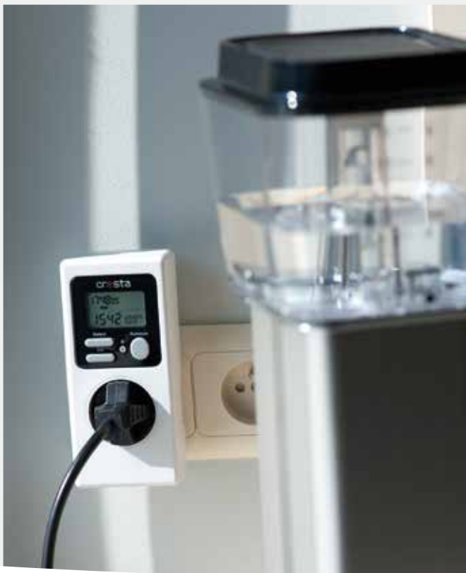
Plaats de energiemeter tussen het stopcontact en het toestel.
